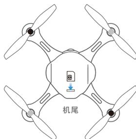
如图所示，按压卡槽内的 SIM 卡，待卡弹出后，轻轻取出即可。
