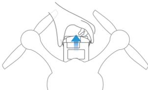
注：请勿在电池开机状态下插拔电池，否则可能会损坏电池。
