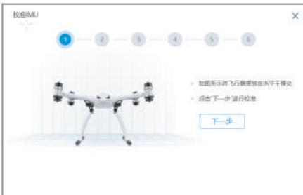
各步骤完成之后，系统会提示是否校准成功，校准失败则重新进行上面的校准步骤即可。
