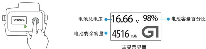
注：待机状态（未开机状态）下，可通过短按电池开关按钮查看电量。（电池屏幕会显示主显示界面，时长约 3 秒，此过程指示灯不亮）
