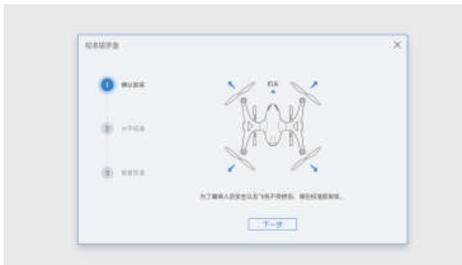
**第 2 步：**如图所示，机头朝前，校准人员手持飞机原地缓慢旋转，直到蓝圈全部点亮，将自动跳转到下一步骤。
