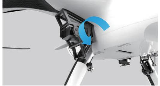
注：绑带用于固定脚架，避免运输过程中脚架晃动。
