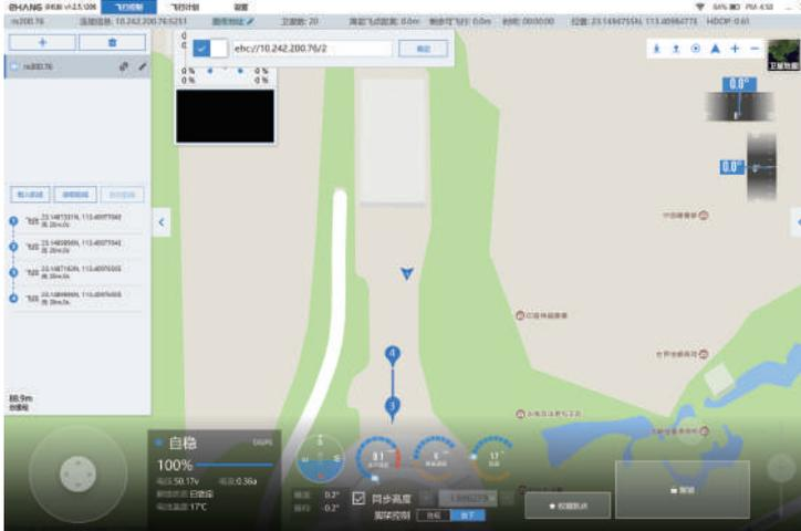
检查后，若发现异常，点击“锁定”按钮，飞机锁定。若无异常，继续点击“起飞”按钮，拖动确认起飞的滑块，飞机将飞至预设高度并悬停，等待下一步操作。
