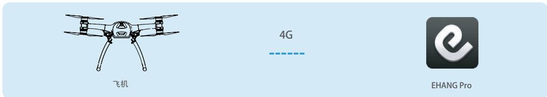
1.开启飞机：将飞机置于水平地面。短按电池电源键，指示灯变常亮，再快速长按，指示灯变为闪动，飞机成功启动。
