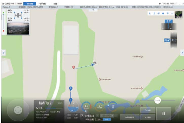
注：当点击“悬停”按钮时，飞机将会减速滑行直至悬停，因此，请注意周围环境，确保航行路线上无障碍物。滑行的距离根据飞机当前飞行速度而定。飞行速度快，滑行距离较长；飞行速度慢，则滑行距离短。
