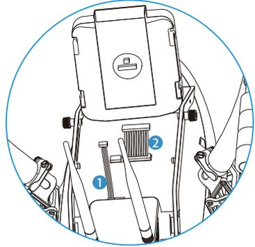
2.将云台上的螺丝依次拧下并取下云台。
