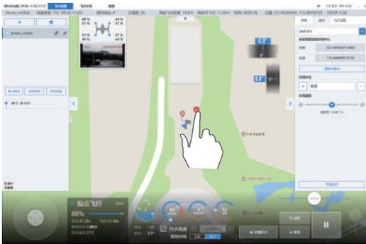
如下图，在设置完成后，点击“开始执行”，飞机即先飞至圆上，再环绕中心点飞行。当环绕一圈后，将继续环绕飞行，需手动点击“停止执行”，飞机即停止飞行并悬停于当前位置。
