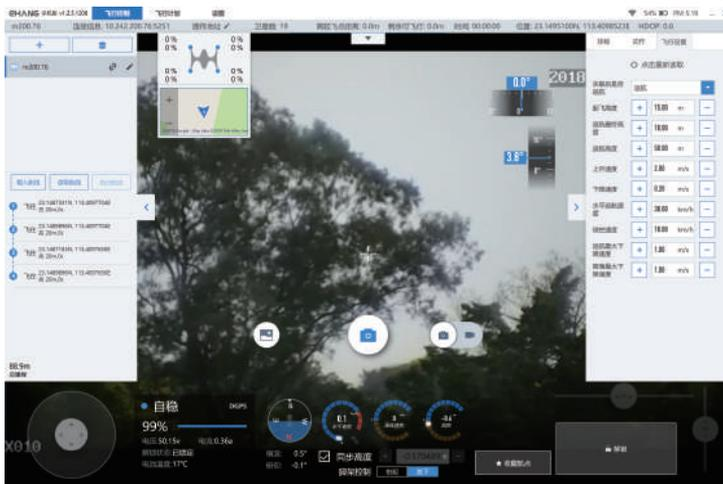
1.失联后是否返航：飞机失去连接后将自动执行预设的动作。建议选择“返航”。
