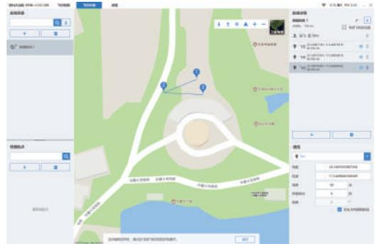
**步骤 6:** 如图，按住 ⚡ 上下拖动可调整航点顺序，注意第一个操作为起飞，请勿改动。
