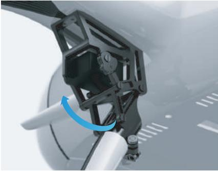
2. 若发现起落架不平衡时，可向外掰开 ② 将 ③ 旋至平衡位置，然后将 ① 往箭头方向旋紧，最后将 ② 往箭头方向锁紧即可。
