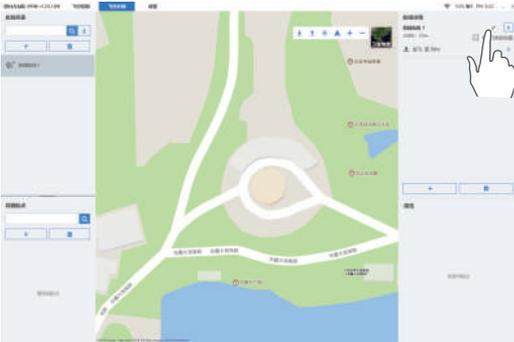
**步骤 3:** 点击右侧的 + 或者双击地图，添加航点。可按住航点拖动来改变航点位置。右下角部分可修改纬度、经度、相对高度、停留时间等航点参数。
