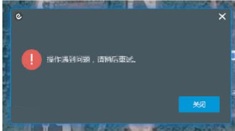
2.当连接飞机时有图2的提示，检查是否在主页面已经连接了该飞机，或者其他应用占用了5251的端口。
