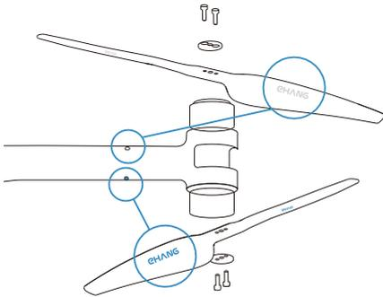
2.蓝色商标螺旋桨对应机臂蓝色圆点标识，螺旋桨的商标朝上，放上垫片，使用内六角螺丝刀拧紧螺丝即可。
