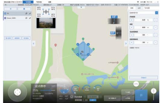
参数设置完成后，飞机将飞往绿色的起点，再按照设定路线飞至红色的终点，然后悬停在终点位置，等待下一步指令。
