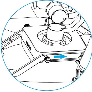
4.将云台两边的螺丝按照顺时针的方向拧紧，如下图所示。
