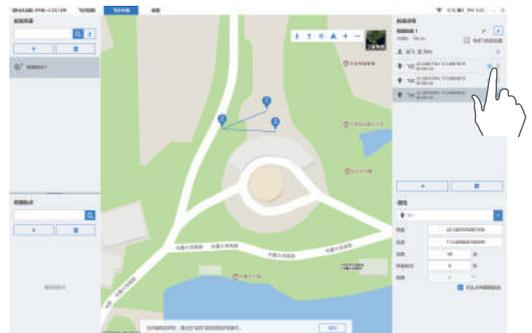
**步骤 7:** 若航线需要三个航点，则需要添加第四个航点，再点击修改属性，则第四个航点则变成飞行动作，例将第四点设置成“返航”。
