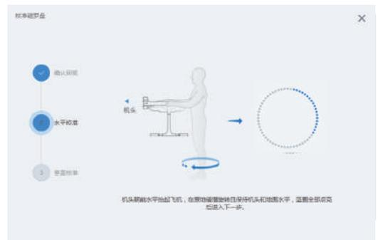
**第3步：**如图所示，机头朝下，校准人员手持飞机原地缓慢旋转，直到蓝圈全部点亮，将自动跳转到下一步骤。
