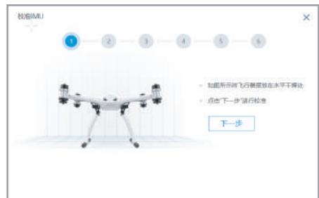
各步骤完成之后，系统会提示是否校准成功，校准失败则重新进行上面的校准步骤即可。
