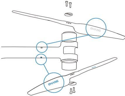
**保养：**长时间不使用飞机，建议拆下螺旋桨，装于绒布袋中，防尘防潮，避免曝晒老化及挤压碰撞。
