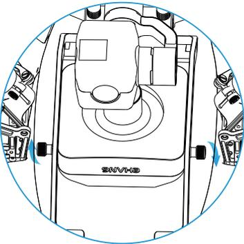
5.将无人机摆正，轻摇云台，检查是否安装稳固，若无法推下，即为安装成功。
