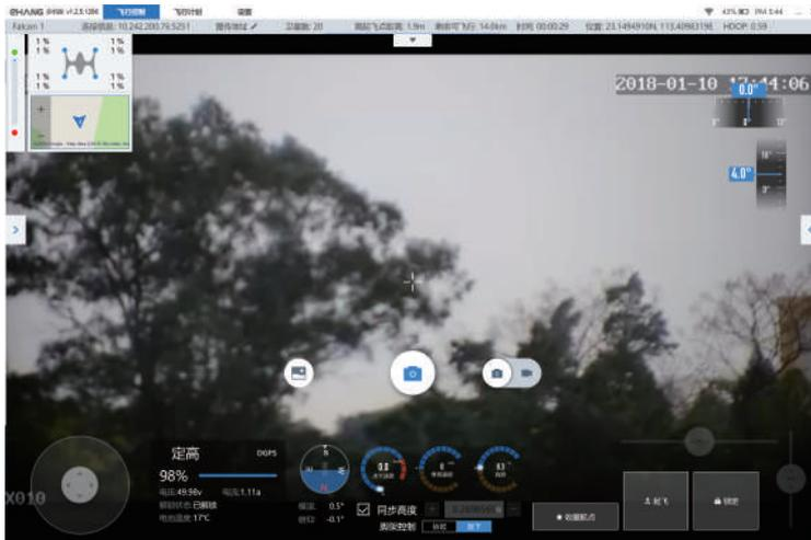
可通过右下角的高度调节拉杆调节飞机高度，然后在地图上选择（单击地图）要飞往的地点，即出现Go图标，Go图标可以被拖动来改变目标位置，点击Go图标，飞机即飞往目的地。
